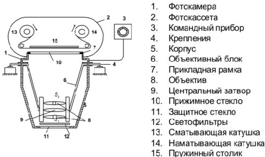
Рисунок 1– Устройство аэрофотоаппарата
