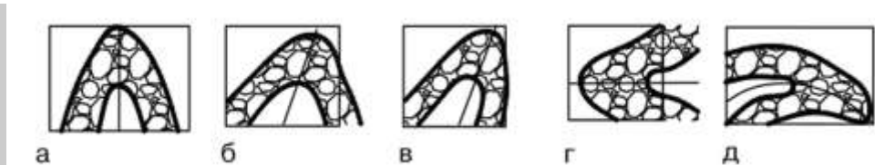
Рис. 3.10. Классификация складок по наклону крыльев и осевой поверхности: а — прямые; б — косые; в — опрокинутые; г — лежащие; д — ныряющие складки
